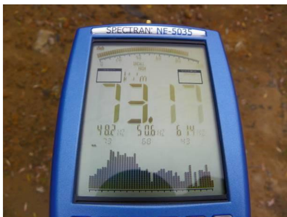
Rysunek 13. Pomiar składowej elektrycznej (na lewo) i składowej magnetycznej (na prawo) w punkcie pomiarowym zlokalizowanym w odległości ok 5m od transformatora 15kV [fot. Krzysztof Kręciproch]
